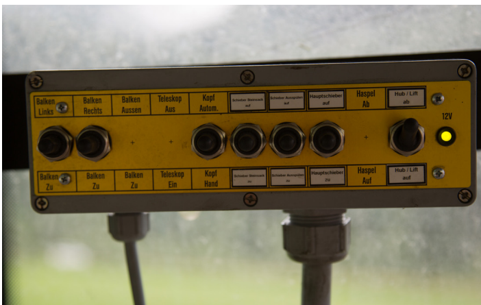
Der Verteiler lässt sich an einem übersichtlichen Steuerungskasten vom Traktorsitz aus bequem elektrohydraulisch bedienen.
