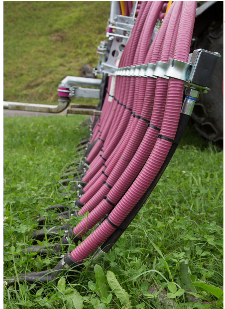
Die Schuhe sind an Kunststoff-Stäben montiert. Diese sind in alle Richtungen flexibel. So kann man problemlos Kurven fahren.
