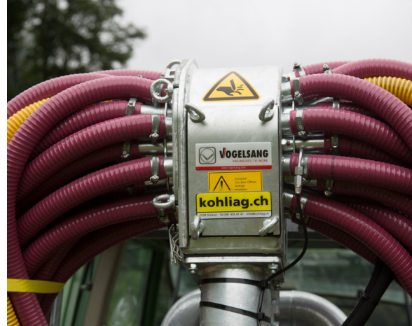
Der Verteilkopf von Vogelsang begeisterte mit einem hohen Durchfluss. Er verstopfte im Test kein einziges Mal.
