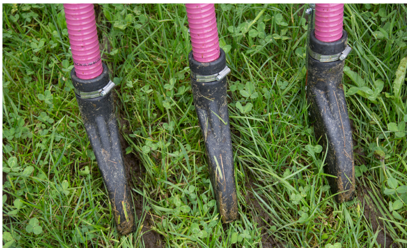
Der Verteiler legt die Gülle auch bei hohen Gaben in schmalen Streifen sauber ab.
